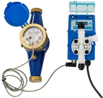
Para evitar estos problemas, se debe tratar al agua con inhibidores químicos mediante bombas dosificadoras que inyecten en función del caudal de agua, para extender el punto de saturación de los materiales insolubles y evitar la formación de incrustaciones y corrosión. El tratamiento de agua en torres es preferible a la utilización de agua dulce debido a problemas ambientales y de costos.
